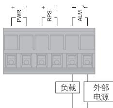
SWITCH 2016GT具有一组继电器报警输出。该继电器使用顶部面板接线端子的两个触点。6针接线端子连接器的两个触点用于检测用户配置事件。当触发用户配置的事件时，连接到故障触点的两根导线将形成开路。如果用户配置的事件没有发生，则故障电路保持闭合。
